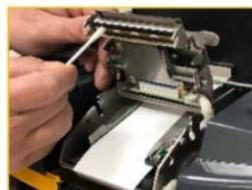
**DIFERENCIAL URANO** - A tampa do mecanismo impressor pode ser aberta quase que totalmente, o que facilita a limpeza ou troca da cabeça térmica prevenindo danos ao mecanismo impressor.
