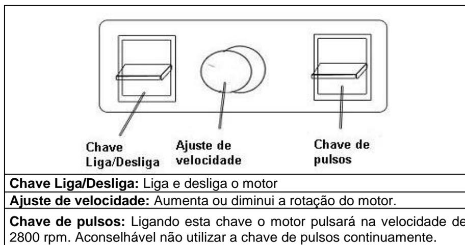
NOTA: Existe uma proteção contra superaquecimento no motor. Caso o motor aqueça demasiadamente a corrente será cortada. Para que o liquidificador volte a operar normalmente, retire a jarra do acoplador do motor e ligue após aproximadamente 2 minutos. O ventilador do motor irá diminuir a sua temperatura tornando-o operável novamente.
