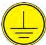
Identifica o terminal que é destinado para conexão com um condutor externo para proteção contra choque elétrico em caso de alguma falha.
