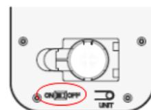
2) Puxe o display para fora, coloque a balança posicionada numa superfície plana, lisa e rígida (evite carpetes ou superfícies macias):
