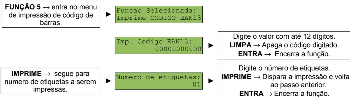
**OBS:** A balança só entra na função de impressão de código de barras caso a balança esteja com a indicação de peso em zero e a indicação de líquido estiver apagada. Se, após a entrada na função, o peso da balança sair de zero, a função será abortada e a mensagem “**Err. 0**” aparecerá no visor de preço/kg. Se houver Tara na balança aparecerá a mensagem “**Err. 2**” no visor do preço por kg e a função será abortada.
