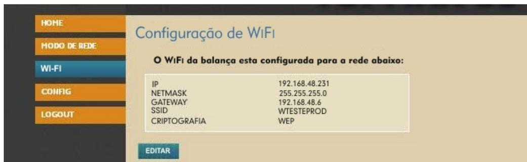
Através da página de “*Configuração de Wi-Fi*”, acessada através de “WI-FI” no menu principal, é possível configurar a conexão sem fio da balança de maneira muito similar a configuração de um roteador wireless. A página acima mostra um exemplo das informações mostradas.
