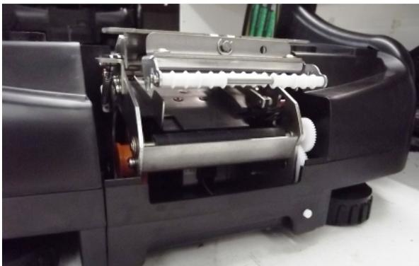
3) Depois de aberto, o suporte da cabeça deverá ficar levantado, conforme a figura. Para que dê espaço para encaixar a proteção de borracha;
