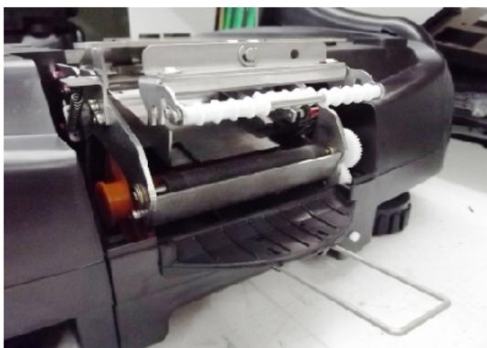
5) Depois de encaixada a proteção de borracha, basta fechar o suporte da cabeça de impressão;
