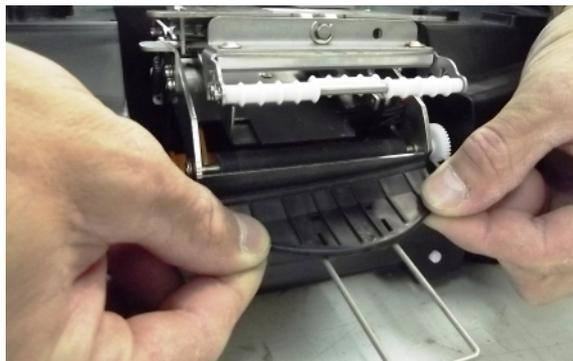
4) Encaixe a proteção de borracha na gaveta, pressionando ela nas extremidades;
