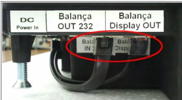
1. Os dois cabos internos da balança já saem de fábrica conectados nas entradas do scanner "Balança IN 232" e "Balança Display IN". Nunca desconecte estes cabos, caso contrário a balança não funcionará.
