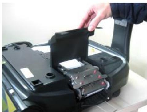
4) Depois de encaixada a proteção de borracha, basta fechar a tampa do mecanismo;
