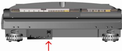
O cabo de rede vai diretamente no conector RJ45 disponível na balança (abaixo do teclado de 40 teclas).
