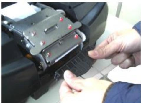
3) Depois de aberto, encaixe a proteção de borracha na gaveta, pressionando ela nas extremidades;
