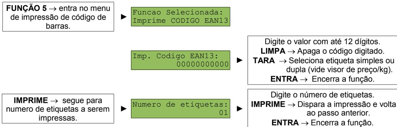
**OBS:** A balança só entra na função de impressão de código de barras caso a balança esteja com a indicação de peso em zero e a indicação de líquido estiver apagada. Se, após a entrada na função, o peso da balança sair de zero, a função será abortada e a mensagem “Err. 0” aparecerá no visor de preço/kg. Se houver Tara na balança aparecerá a mensagem “Err. 2” no visor do preço por kg e a função será abortada.
