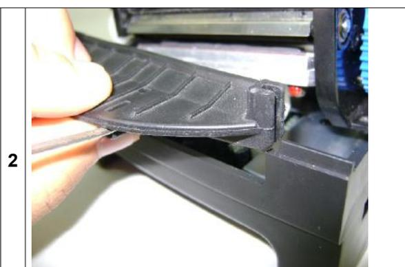
Insira a proteção de borracha no encaixe da gaveta do mecanismo.
