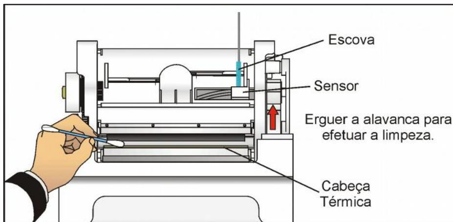
A limpeza deve ser efetuada sem a bobina de papel na impressora. Sugerimos que a limpeza seja efetuada quando houver a troca da bobina.
