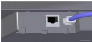
O cabo de rede vai diretamente no conector RJ45 disponível na balança (abaixo do teclado de 40 teclas).
