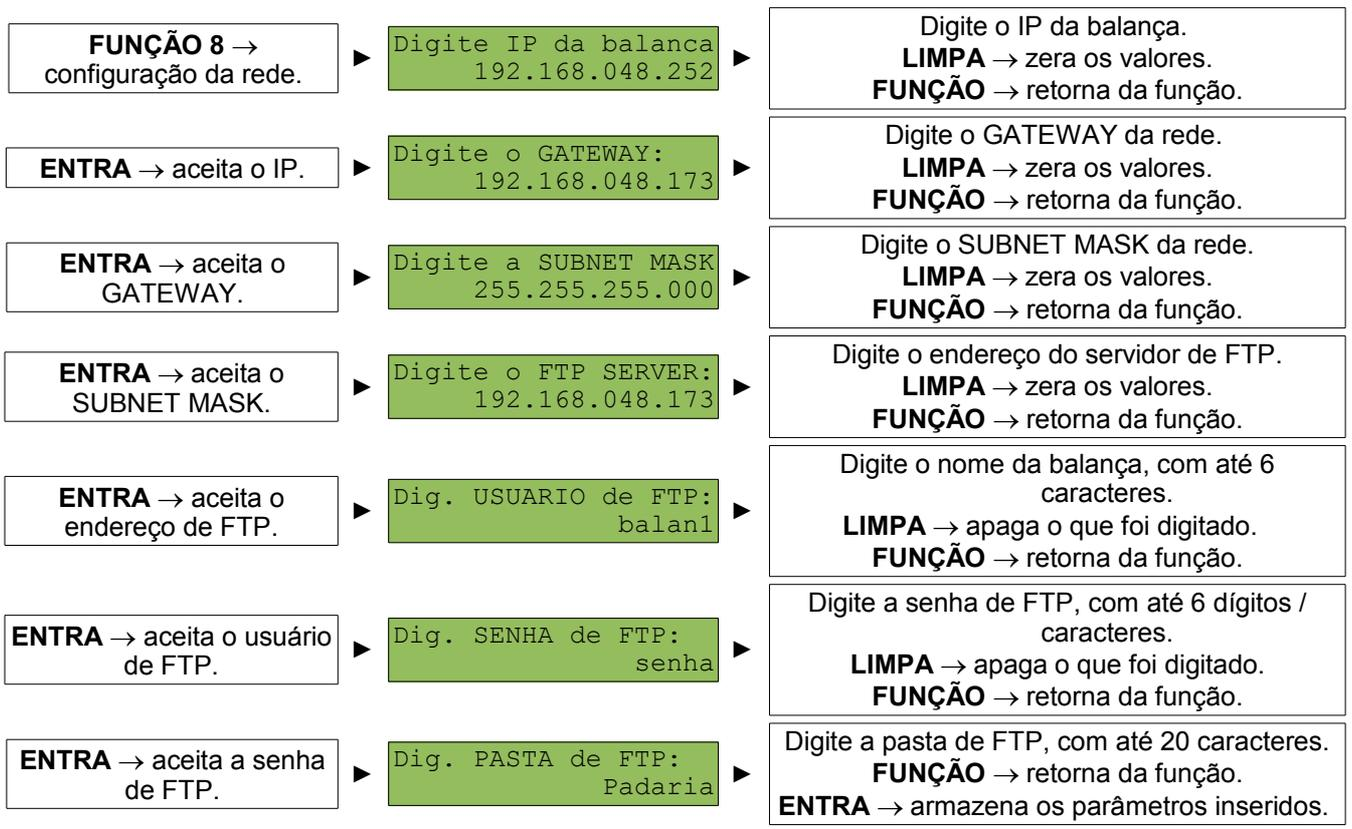
**OBS:** Ao armazenar os parâmetros inseridos, a balança emite um sinal sonoro para indicar se a armazenagem foi realizada com sucesso. 1 bip curto: armazenagem realizada com sucesso. 2 bips longos: insucesso na armazenagem.
