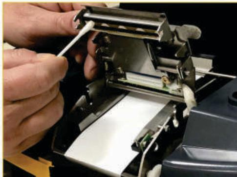
**DIFERENCIAL URANO** - A tampa do mecanismo impressor da **B35** pode ser aberta quase que totalmente, o que facilita a limpeza ou troca da cabeça térmica prevenindo danos ao mecanismo impressor.
