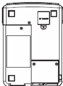
1. Remova a tampa chaves DIP na parte inferior da impressora.
