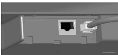
Caso a balança não possua módulo de TCP-IP interno. O módulo externo deve ser conectado no conector RJ45 da balança e o cabo de rede no conector RJ45 do módulo.
